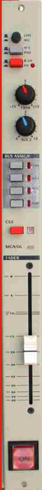
Cada **módulo de entrada** puede utilizarse tanto para señales de micrófono o de línea (mono o estéreo) Posee teclas de selección de la señal entrante LIN/MIC, pad de 20 dB de atenuación y phantom asignable desde el frente. Cuenta con fader Alps de 100mm, llave ON/OFF Veetronix, led indicador de overload y control de ganancia TRIM.
