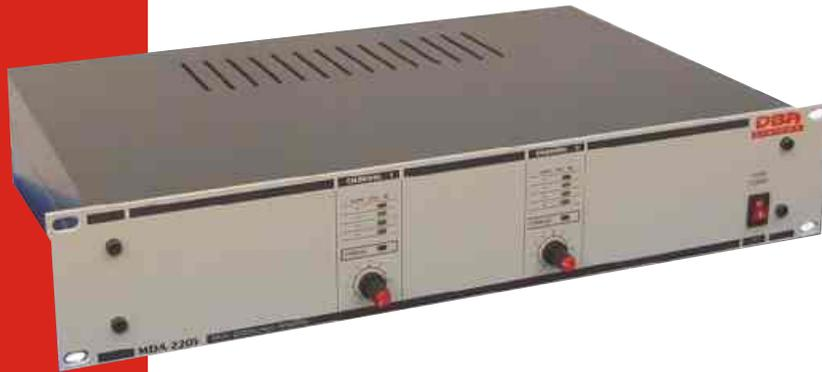
El **MDA-2205** de **DBA SYSTEMS**® es un distribuidor de audio de 2 canales de entrada y 5 salidas por canal.
